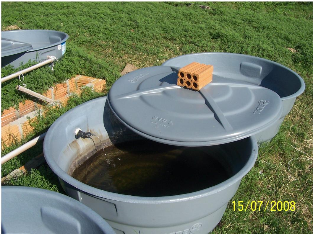
Anexo 2: Tanque utilizado no experimento (detalhe entrada d'água).
