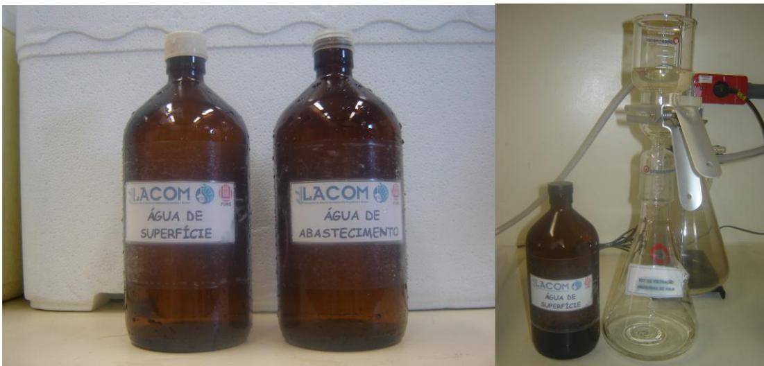
**Figura 9 - Frascos âmbar e sistema de filtração das amostras**
